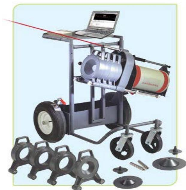
Figura25: Sistema ISOCS per caratterizzazione in campo
