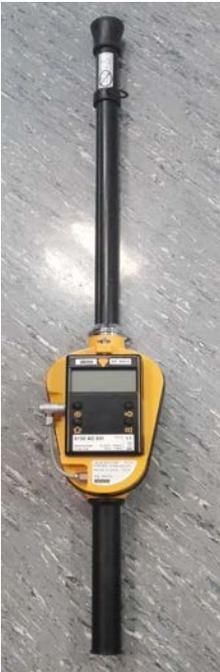
Figura 23: Misuratore di dose portatile a batteria
